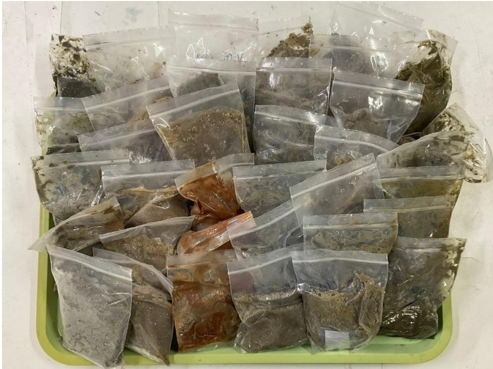
รูปที่ 12 ตัวอย่างตะกอนดินสำหรับวิเคราะห์ขนาดอนุภาคตะกอนดิน (Grain size)
