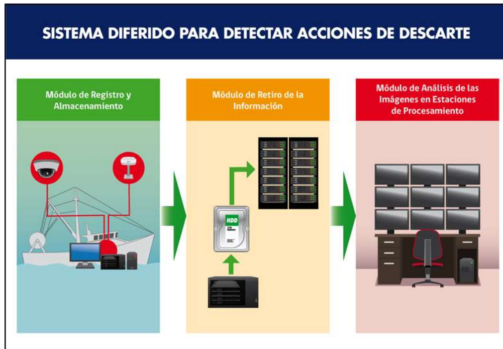
Figura 2. Esquema Sistema de fiscalización del descarte mediante DRI. Fuente: SERNAPESCA.
