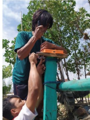
Gambar 2. Pemasangan TREKfish di bagian depan (haluan) perahu yang terpapar langsung dengan sinar matahari.
