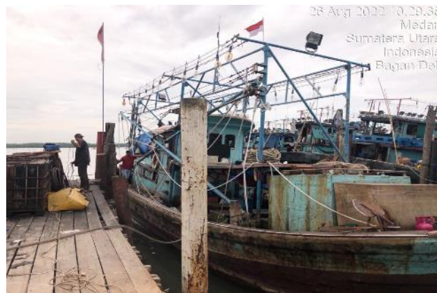
Gambar 31. Kapal Penangkap cumi tipe Bouke Ami di PPS Belawan
