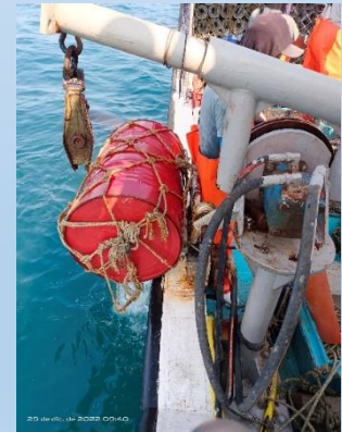
e. Flotador (tanque de petróleo vacío)
