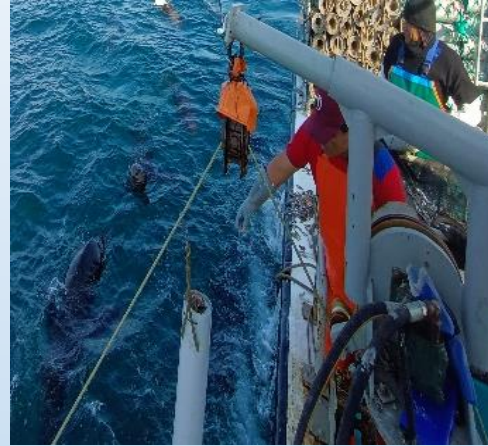
Figura 5.6. Nudo de retención en el brazo telescópico del winche.
