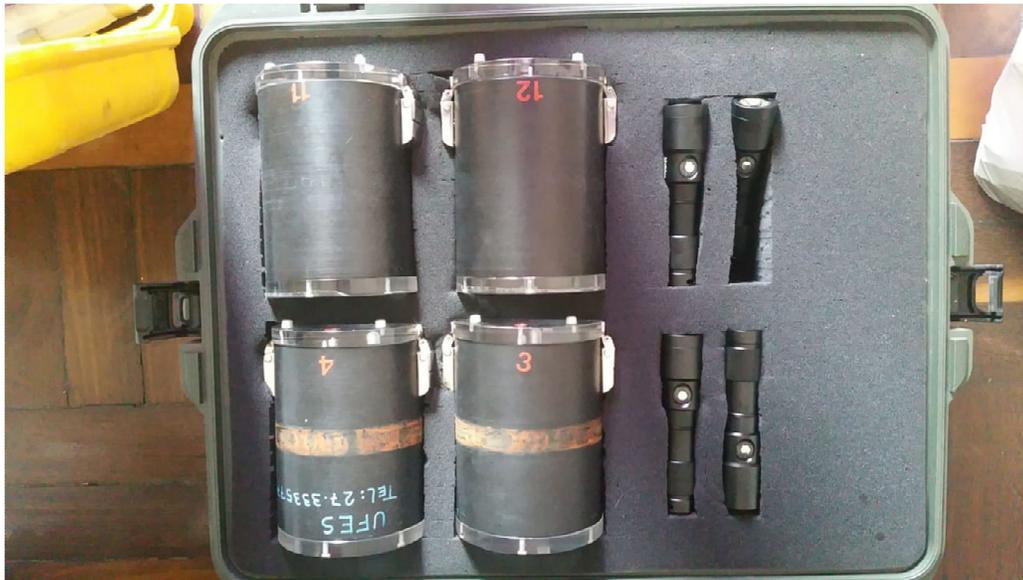
**Figura 2:** Equipamento de filmagem subaquática usado no estudo piloto: caixas estanques contendo câmeras GoPro Hero 3 e 3+ Black à esquerda e lanternas subaquática Seasub Big Blue 1200lumens à direita, ambos abrigados numa mala de proteção hard case.
