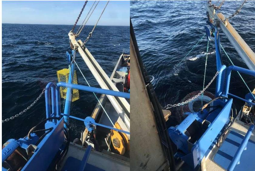
Figure 2: Halage du casier cordage sur-demande et d'une trappe traditionnelle
