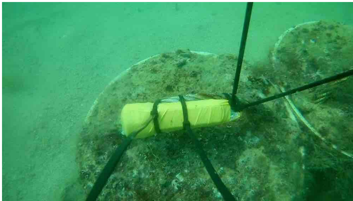
Figura 5. Registrador HOBO U22 instalado en el sitio frente a la Zona de Manejo Integral.
