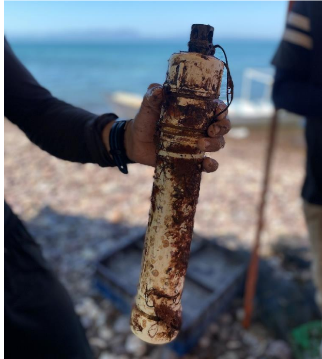
Figura 6. Sensor de oxígeno Disuelto HOBO u-26, instalado en la Zona de Manejo Integral
