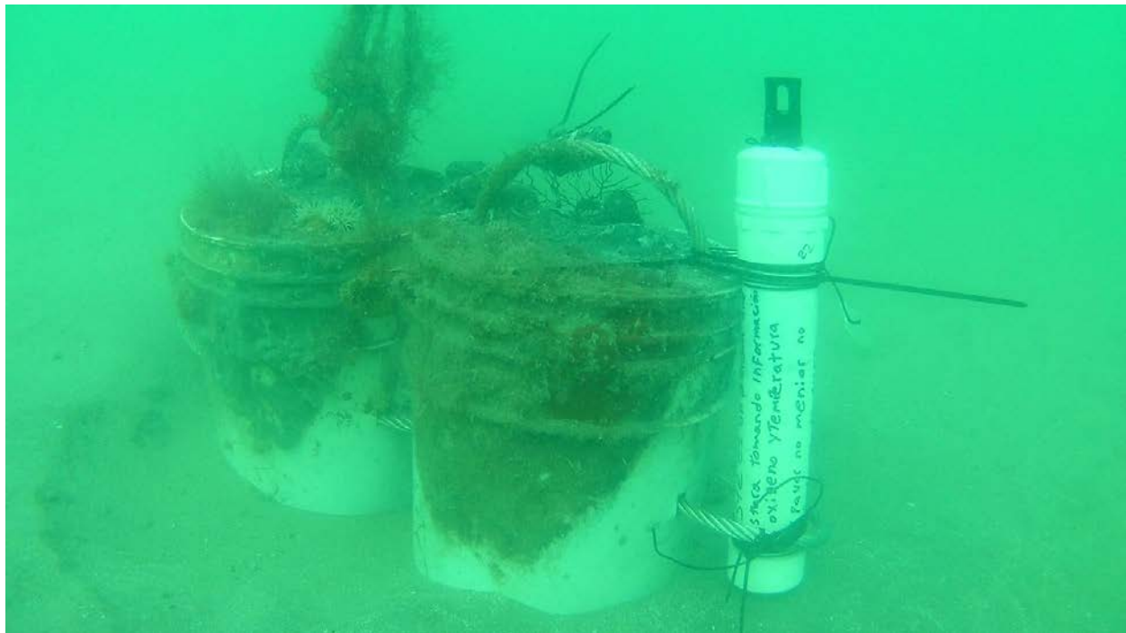
Figura 2. Sensor HOBO que mide oxígeno disuelto, instalado en el sistema de anclaje dentro de la Zona de Manejo Integral.
