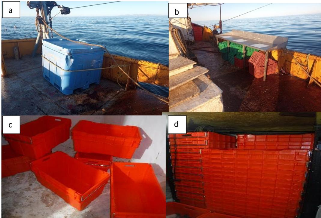
Figura 2. Estructura y equipo implementado en los barcos durante el piloto de inversión de mejora de valor para la pesquería de merluza. a) Adaptación de bodega, b) Taras de plástico, c) Mesas de acero y d) Tina para lavado de pescado.
