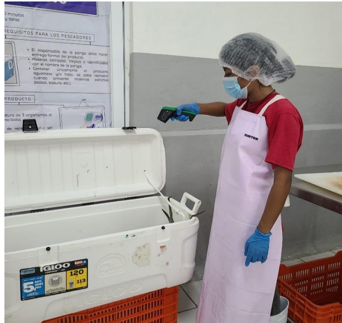
Figura 4.23. Medición de temperatura del producto. Fuente: elaboración propia.
