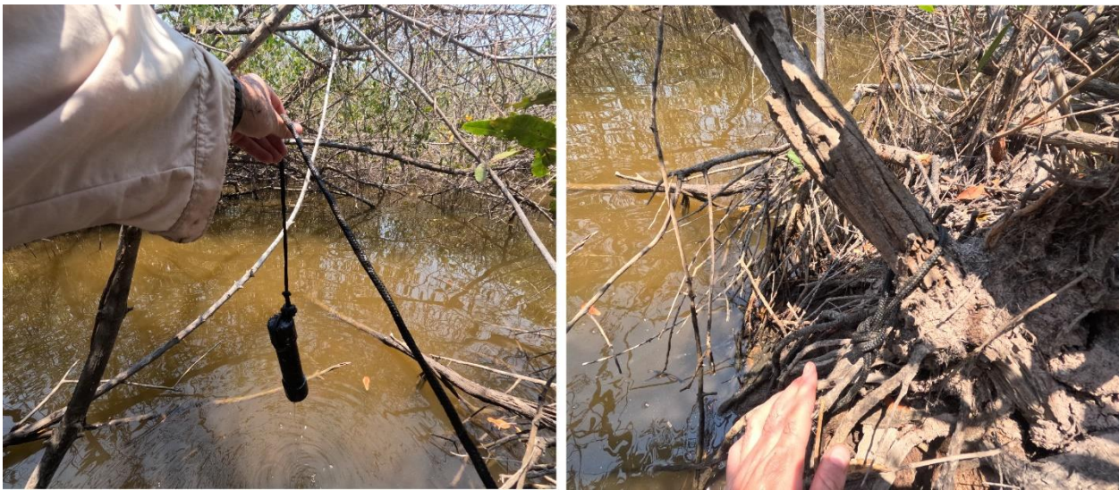
Figura. Fotografías de campo de la instalación de los sensores de nivel de agua.
