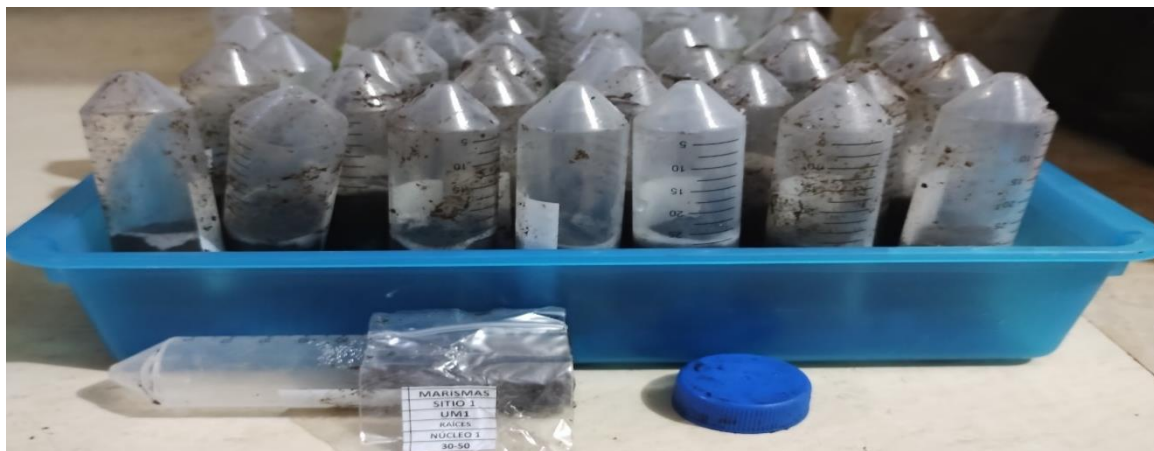
Foto: Toma de muestras para carbono en sedimento a un metro de profundidad, las muestras se congelan para su posterior procesamiento en laboratorio especializado.
