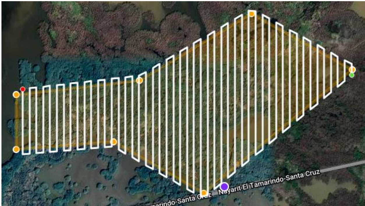
Figura 14. Plan de vuelo para el sitio de Unión de Corrientes.
