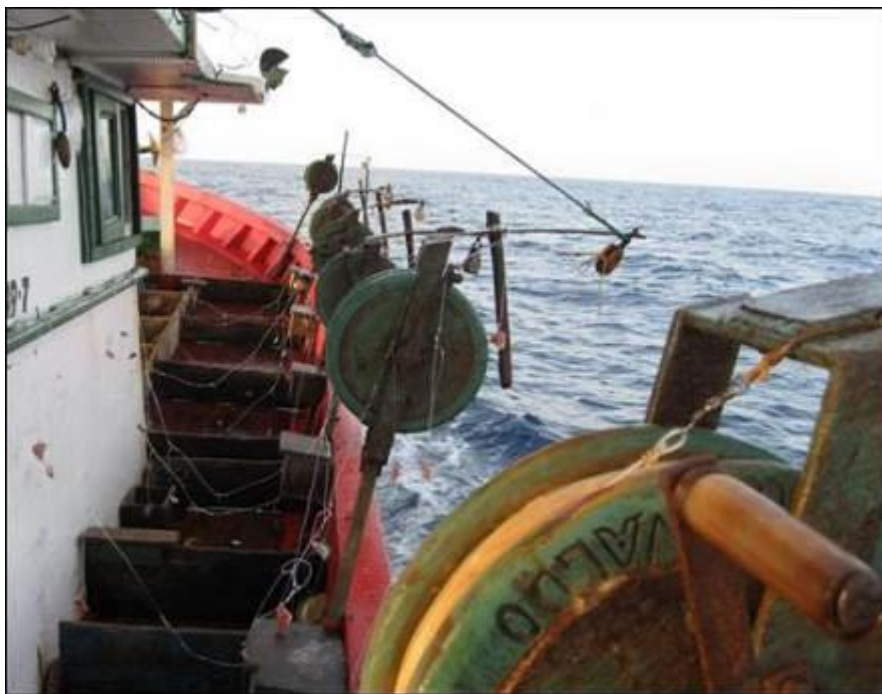
Figura 32: Desenho esquemático de 'bicicleta' (guincho manual) utilizada para lançamento e içamento de linha pargueira, em pescarias comerciais de pargo ( Lutjanus purpureus ) na costa norte do Brasil.
