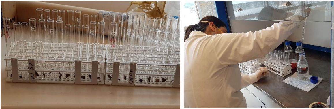
**Figura 28.** Izquierda fragmentos de frondas en tubos de ensayo. Derecha adición de Acetal – resorcinol a tubo de ensayo con trozo de fronda.
