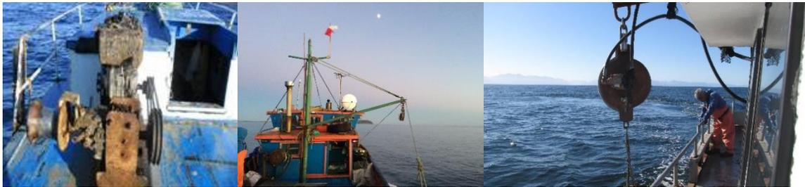
**Figura 27.** Tipos de viradores usados en la Región de Los Lagos. De izquierda a derecha se observan el Winche, la pluma y el sistema hidráulico (Fotografía: Mauricio Sáez)
