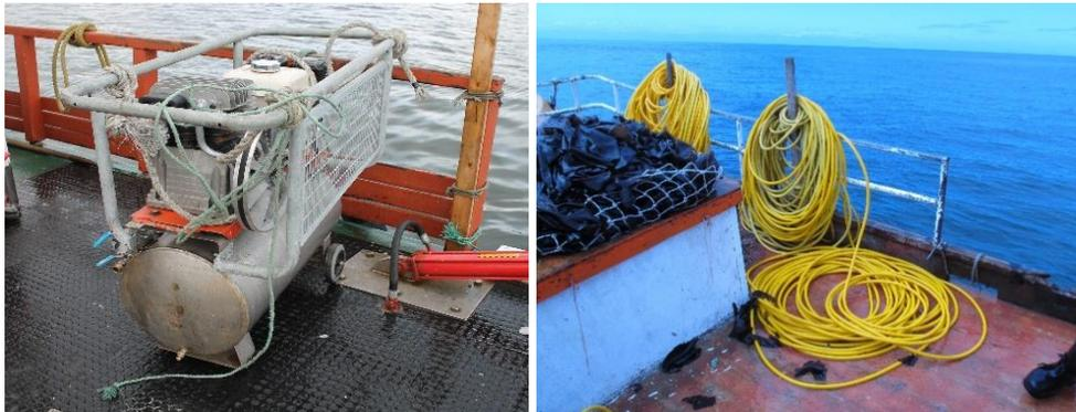
**Figura 20.** Sistema de buceo semiautónomo Hoocka. Izquierda: se observan el motor, compresor y el acumulador de aire. Derecha: la manguera amarilla de 9 mm y 100m de largo. (Fotografía: Paulo Mora).
