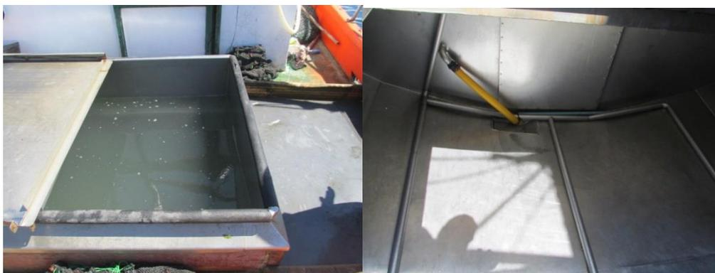
**Figura 17.** Sistema de bodega de acero inoxidable, con agua circulante para transportar con vida a jaibas y centollas en la Región de Los Lagos y Aysén. Año 2018 (Fotografía: Mauricio Sáez).
