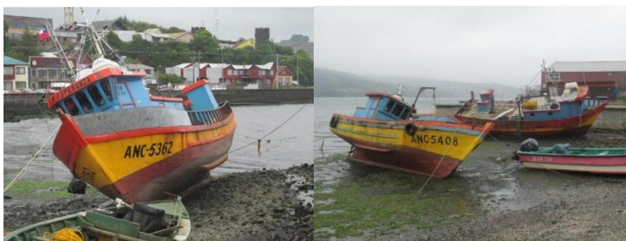
**Figura 13.** Embarcación trampera ancuditana. Se realizan varamientos anuales y bi- anuales para verificar estado del casco y reparaciones (Fotografía: Paulo Mora).
